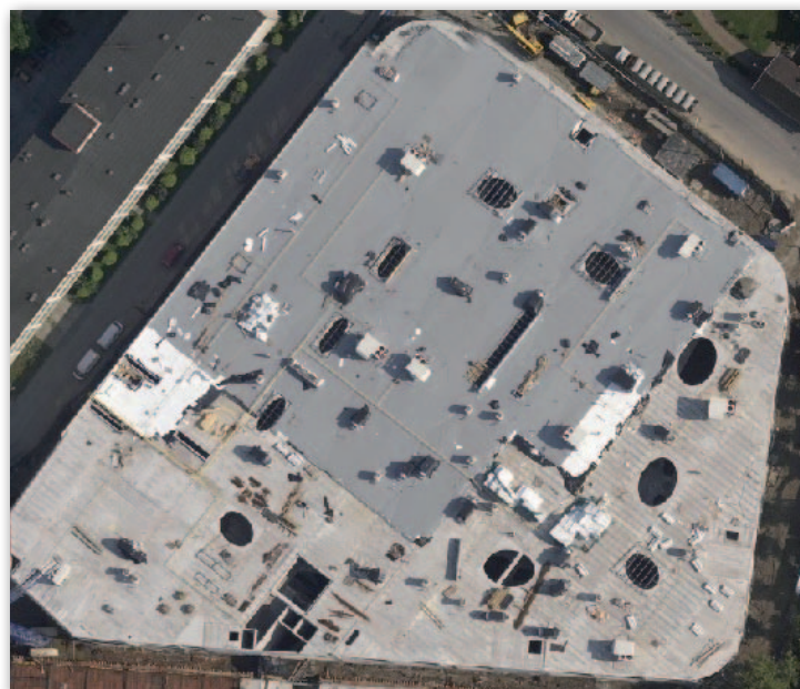
Rys. 4. Problematyczna dla algorytmów filtracji struktura dachu z otworami wentylacyjnymi (fot. z archiwum AGH)
