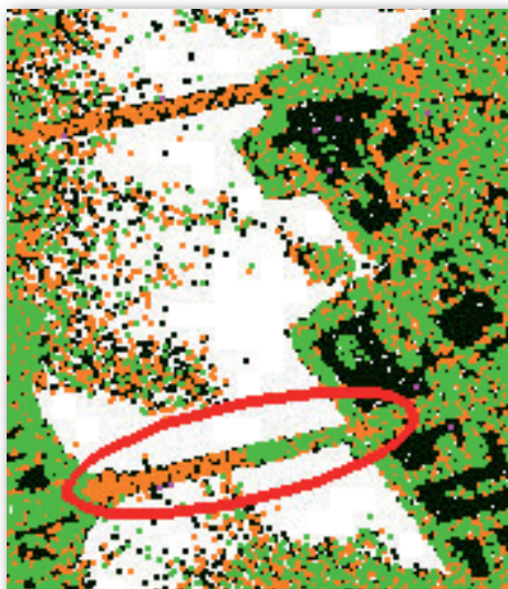
Rys. 7. Testowy obszar Helsinek na zdjęciu satelitarnym z zasobów NLS i różnice w klasyfikacji gruntu dla okolic mostów (widocznych w lewym górnym rogu zdjęcia) przez LASground (na zielono, pierwszy plan) oraz TerraScan (na pomarańczowo)
