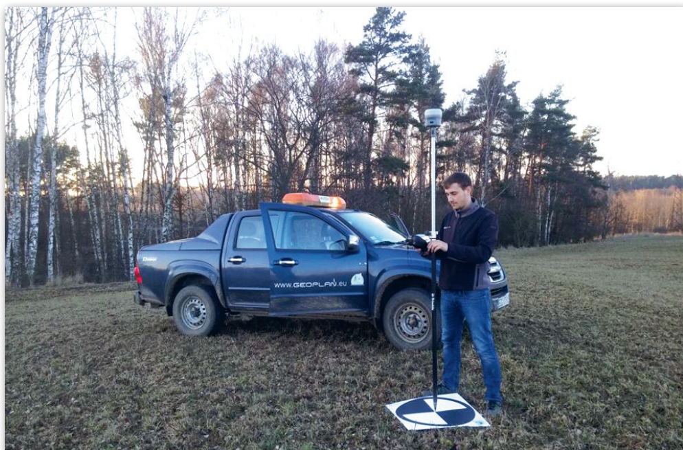
By zachować odpowiednią dokładność ortofotomapy z drona, przed nalołem niezbędne jest wyznaczenie fotopunktów
