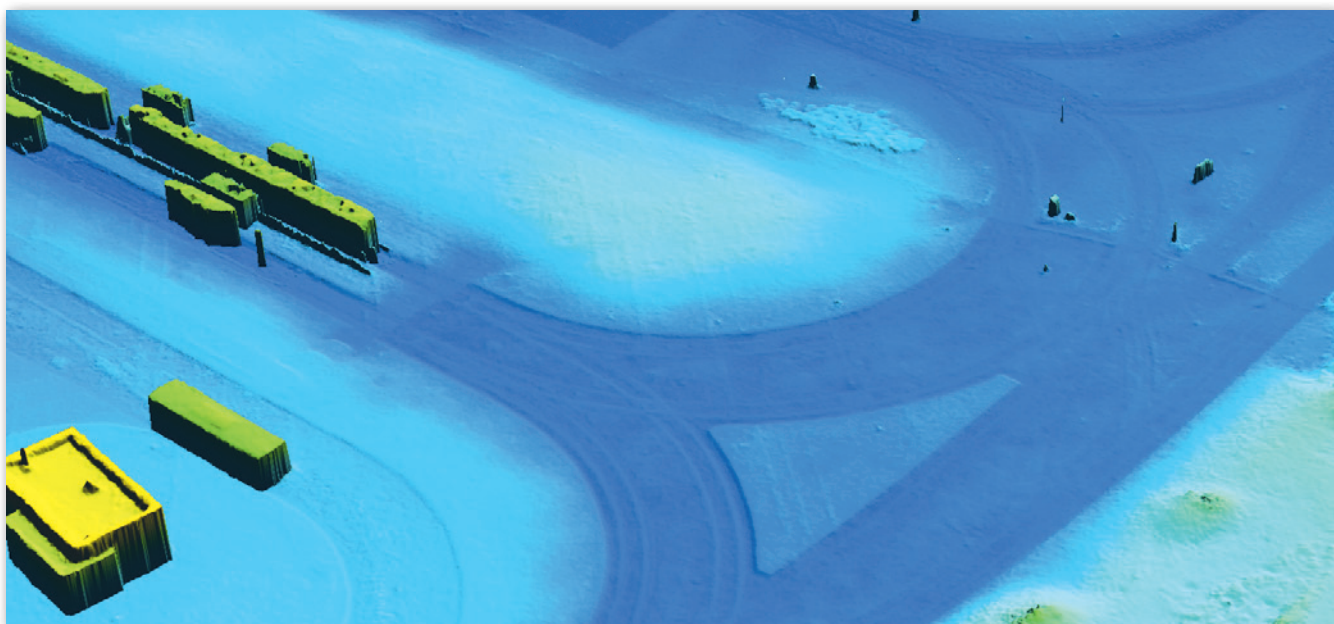
Numeryczny model terenu na bazie zdjęć z drona opracowany na potrzeby koncepcji budowy wiaduktu nad trasą kolejową. Na rysunku widoczny jest fragment jednej z pętli tramwajowych w Poznaniu
