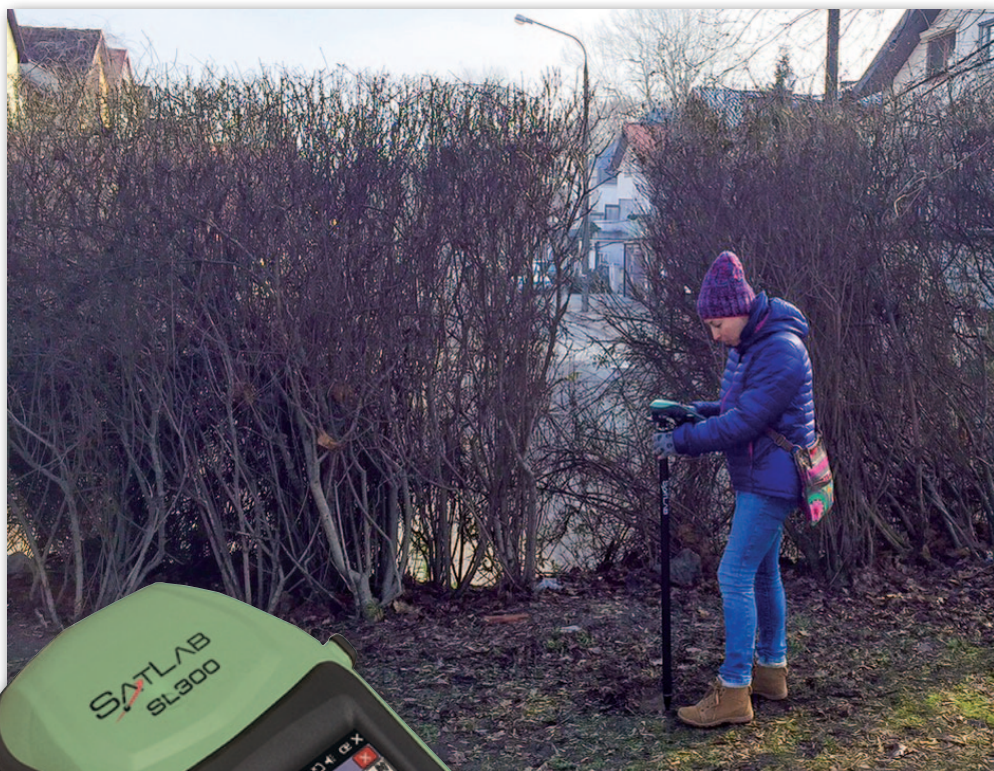
Pomiar realizowany za pomocą odbiornika SATLAB SL300 na metrowej tyczce
