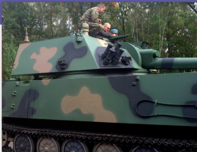
Stonex S9 przy pomiarach weryfikacyjnych wewnętrznych systemów nawigacyjnych (opartych na modułach GPS i inercyjnym systemie Tal-lin 5000) moździerza „RAK” kaliber 120 mm
