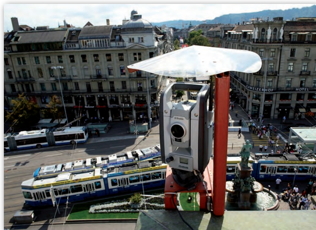
Trimble S8 monitorujący dworzec w Zurychu
