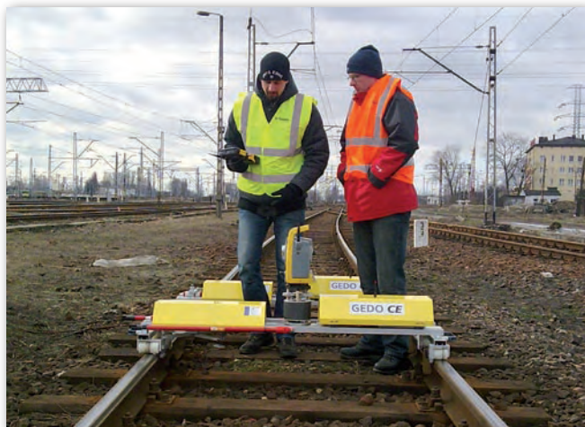
System GEDO CE do mobilnego pomiaru szlaków kolejowych
